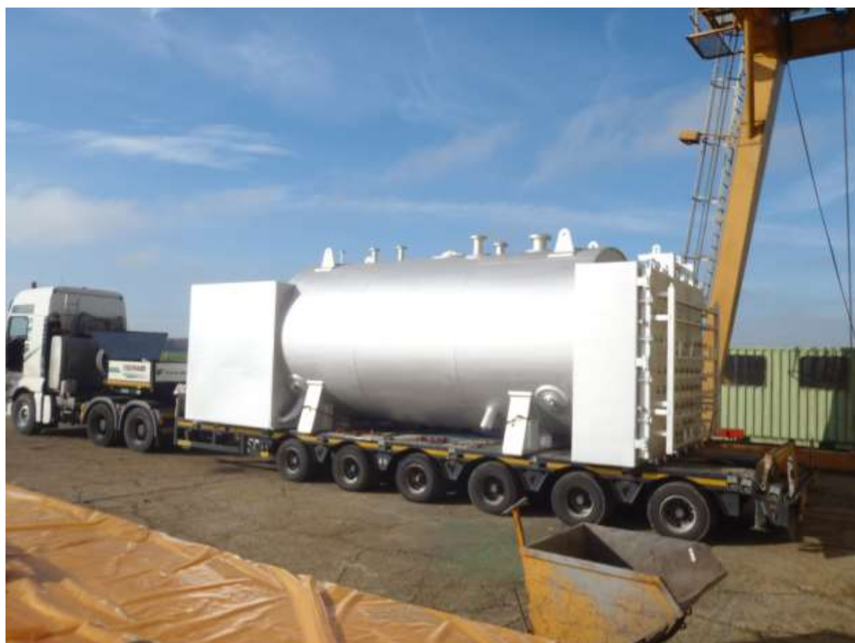
Figure 5.4 : Chaudières à tubes de fumée
