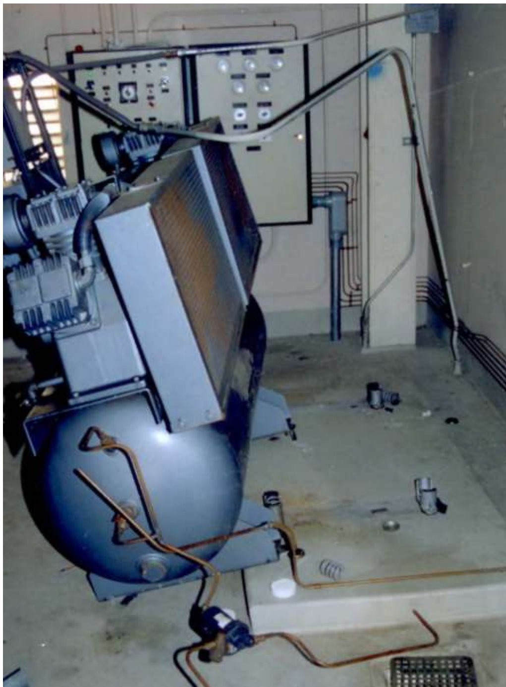
Figure 6.2 [65] Défaillance d'un compresseur monté sur des isolateurs de vibrations Séisme de Northridge, Californie USA 1994
